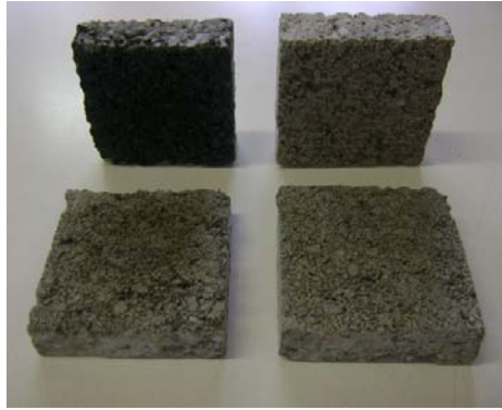
FIGURA 3.23 – PRISMAS PARA ENSAIO DE DETERMINAÇÃO DAS CARACTERÍSTICAS TÉRMICAS
