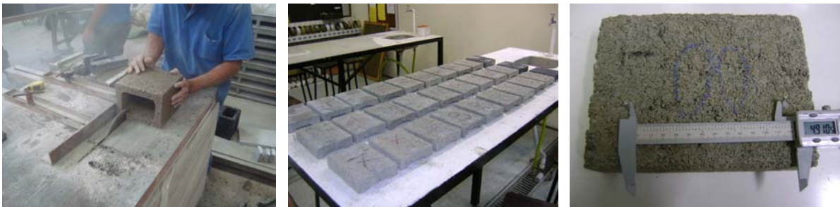
FIGURA 3.22 - PREPARAÇÃO DOS PRISMAS E ENSAIO DE RETRAÇÃO POR SECAGEM
