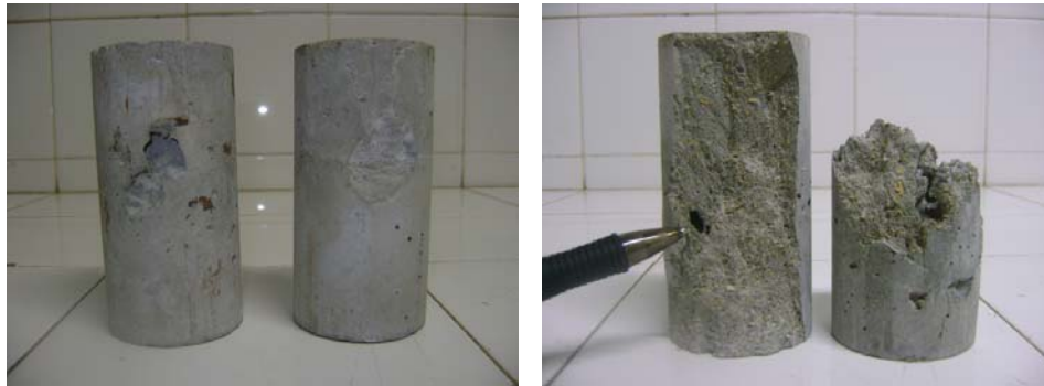
FIGURA 4.24 - MACROPOROS NO COMPÓSITO COM 20% DE SÍLICA ATIVA E 4,4% DE ADITIVO SUPERPLASTIFICANTE
