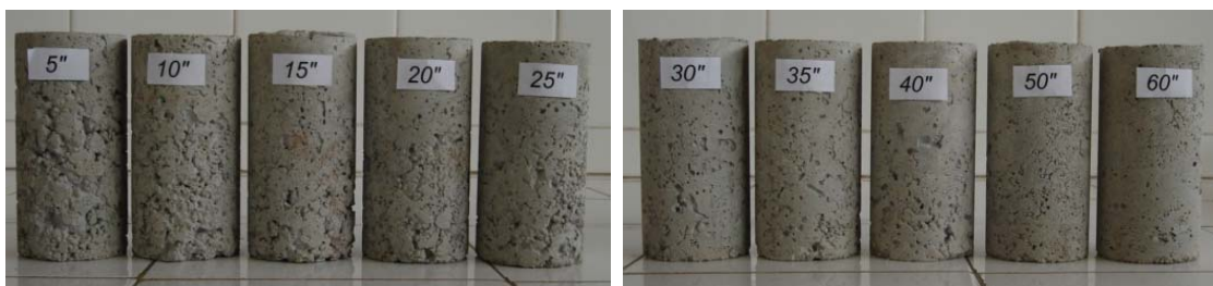
FIGURA 3.17 - CORPOS-DE-PROVA PRODUZIDOS COM DIFERENTES TEMPOS DE MOLDAGEM NO SISTEMA ALTERNATIVO DE VIBRO-COMPRESSÃO
