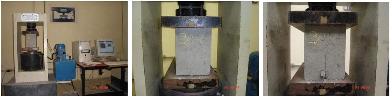
FIGURA 3.14 - DETERMINAÇÃO DA RESISTÊNCIA À COMPRESSÃO DOS BLOCOS
