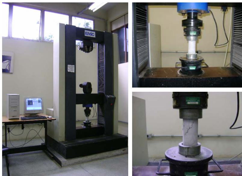
FIGURA 3.8 - CORPOS-DE-PROVA CILÍNDRICOS: ENSAIO PARA DETERMINAÇÃO DA RESISTÊNCIA À COMPRESSÃO
