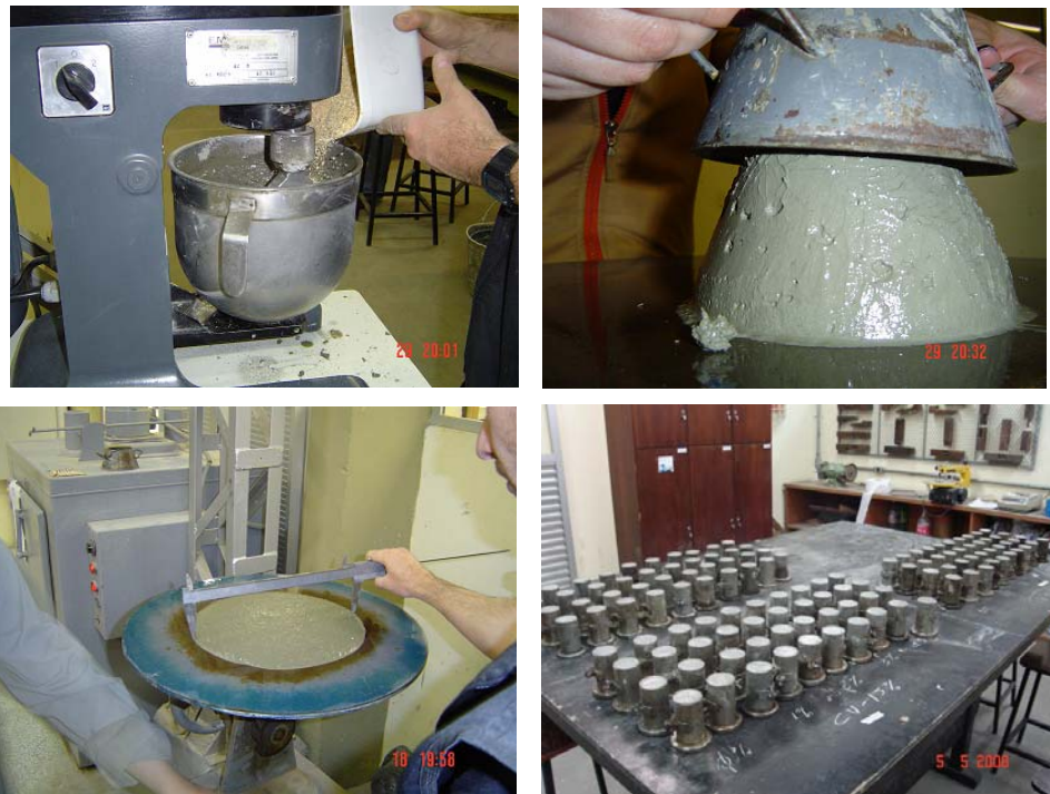
FIGURA 3.5 - SEQUÊNCIA DE PREPARAÇÃO DOS CORPOS-DE-PROVA CILÍNDRICOS: MISTURA MECÂNICA, DETERMINAÇÃO DA CONSISTÊNCIA E CURA INICIAL
