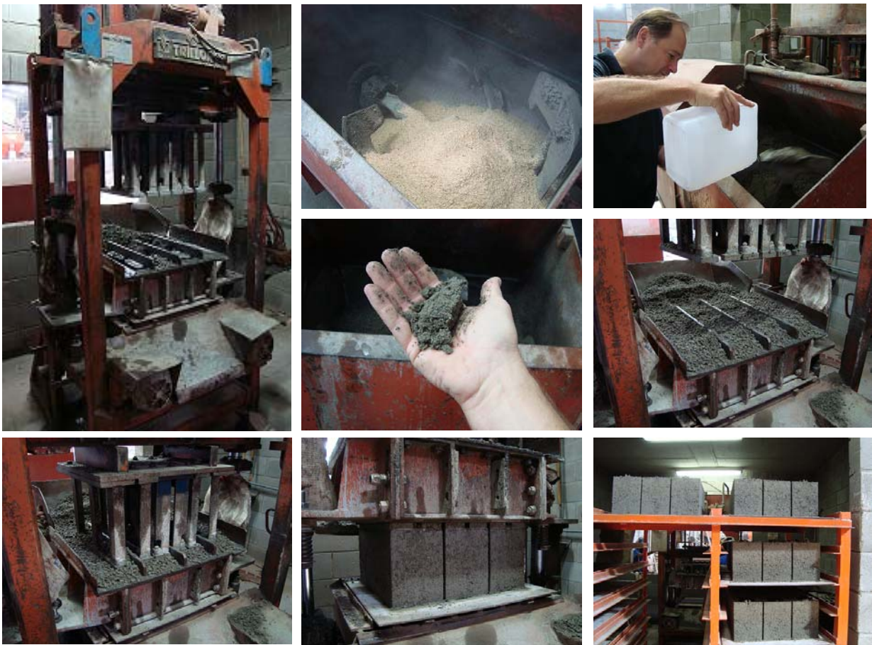
FIGURA 3.13 - EQUIPAMENTO UTILIZADO E SEQUÊNCIA DE TRABALHOS PARA PRODUÇÃO DOS BLOCOS
