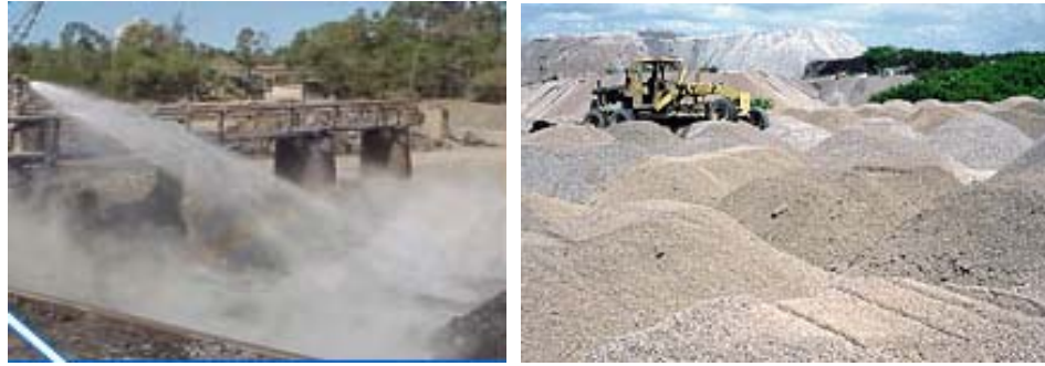
FIGURA 2.10 - RESFRIAMENTO RÁPIDO E ESTOQUE DE ESCÓRIA DE ALTO FORNO Fonte: Arcelor Mittal Brasil (2009)
