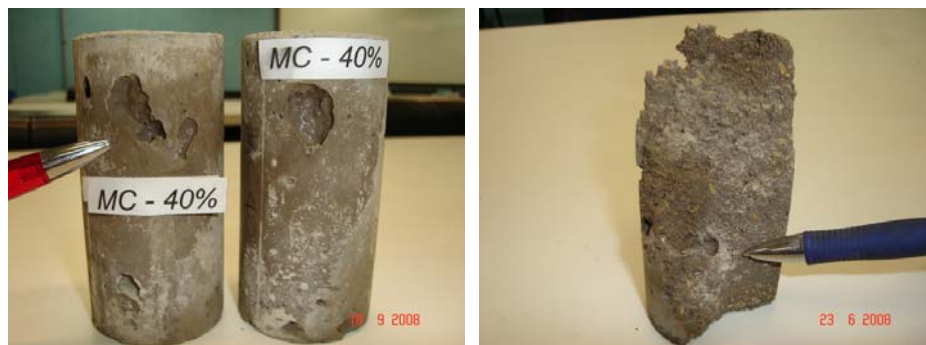
FIGURA 4.26 - MACROPOROS NOS COMPÓSITOS COM 40% DE METACALIM E TEORES DE SUPERPLASTIFICANTE ENTRE 5,8% E 7,8%
