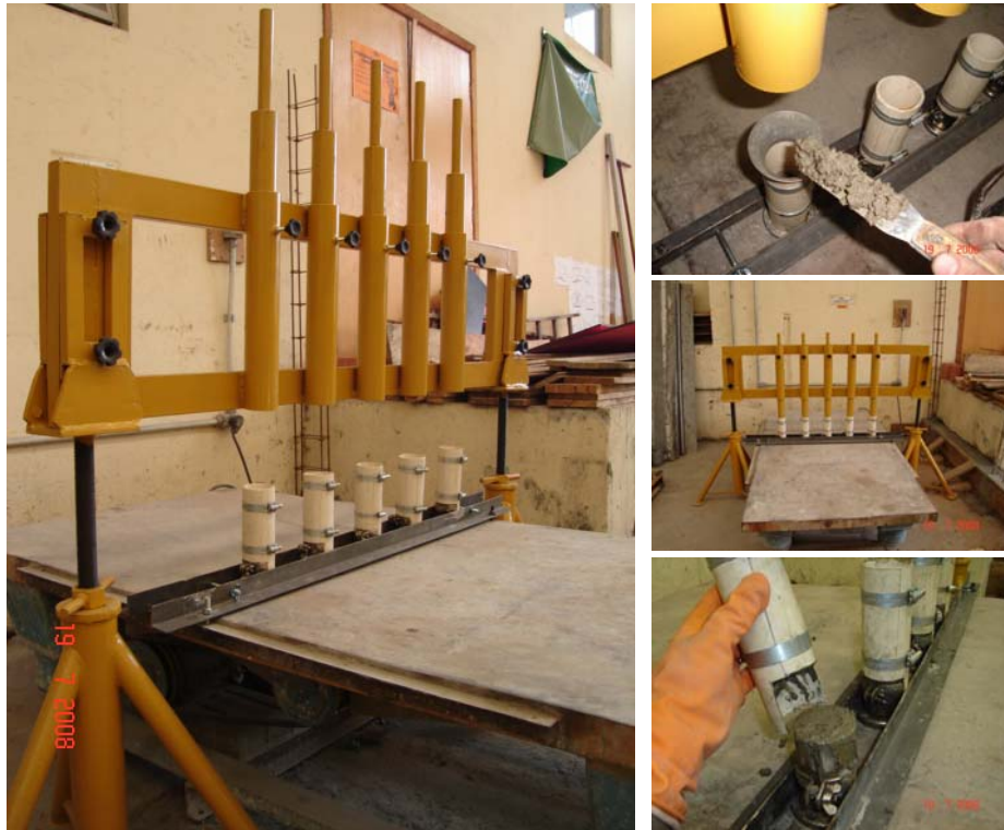
FIGURA 3.16 - SISTEMA ALTERNATIVO DE MOLDAGEM POR VIBRO-COMPRESSÃO
