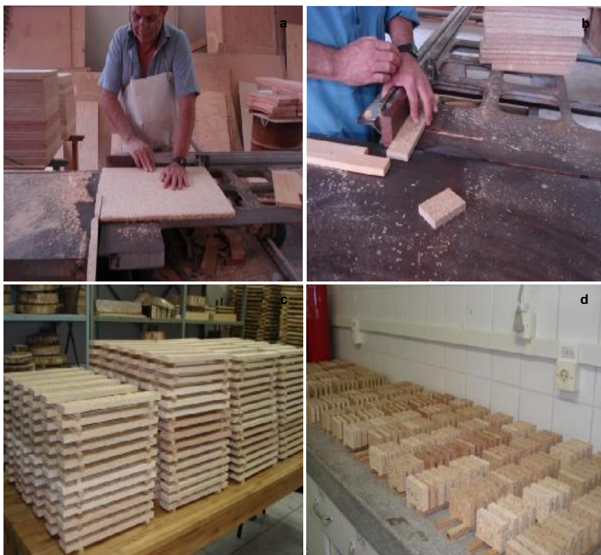
FIGURA 16 – CONFEÇÃO DOS CORPOS DE PROVA E CLIMATIZAÇÃO
