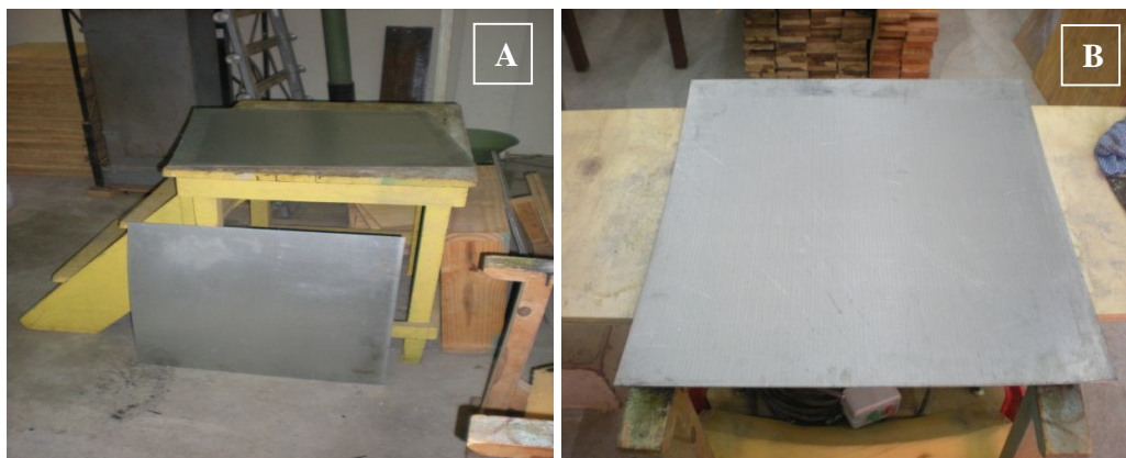
FIGURA 21 – FÔRMAS DE AÇO INOXIDÁVEL PARA PLACAGEM
