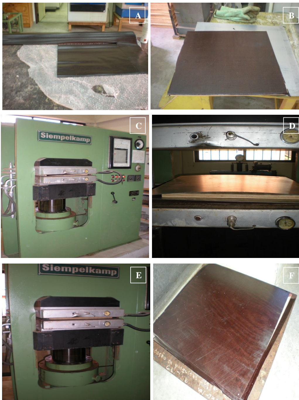
FIGURA 22 – PROCESSO DE PRODUÇÃO DO COMPENSADO PLASTIFICADO
